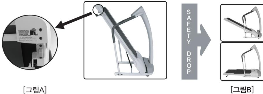
본체를 앞으로 밀었다가 [그림A]에 안전버튼을 누른상태에서 본체를 서히 아래로 잡아 내린 다음 손을 놓아 주십시오.이 제품은 안전설계(Safety Drop) 방식으로 설계되어 손을 놓으면 런닝테크가 천천히 아래로 내려오게 됩니다.
